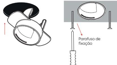
3. Após fixar o nicho no teto, coloque a proteção de papelão conforme imagem abaixo (a).
